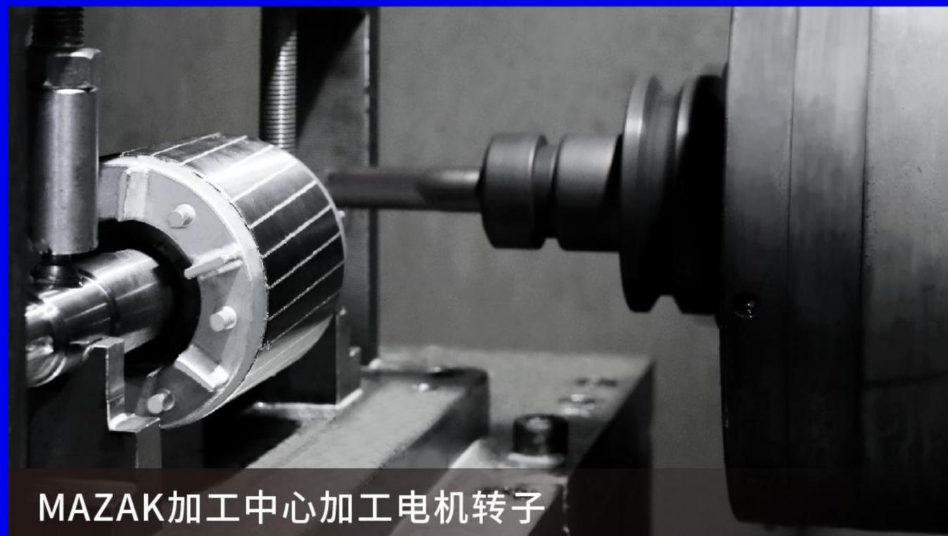
MAZAK加工中心加工电机转子
